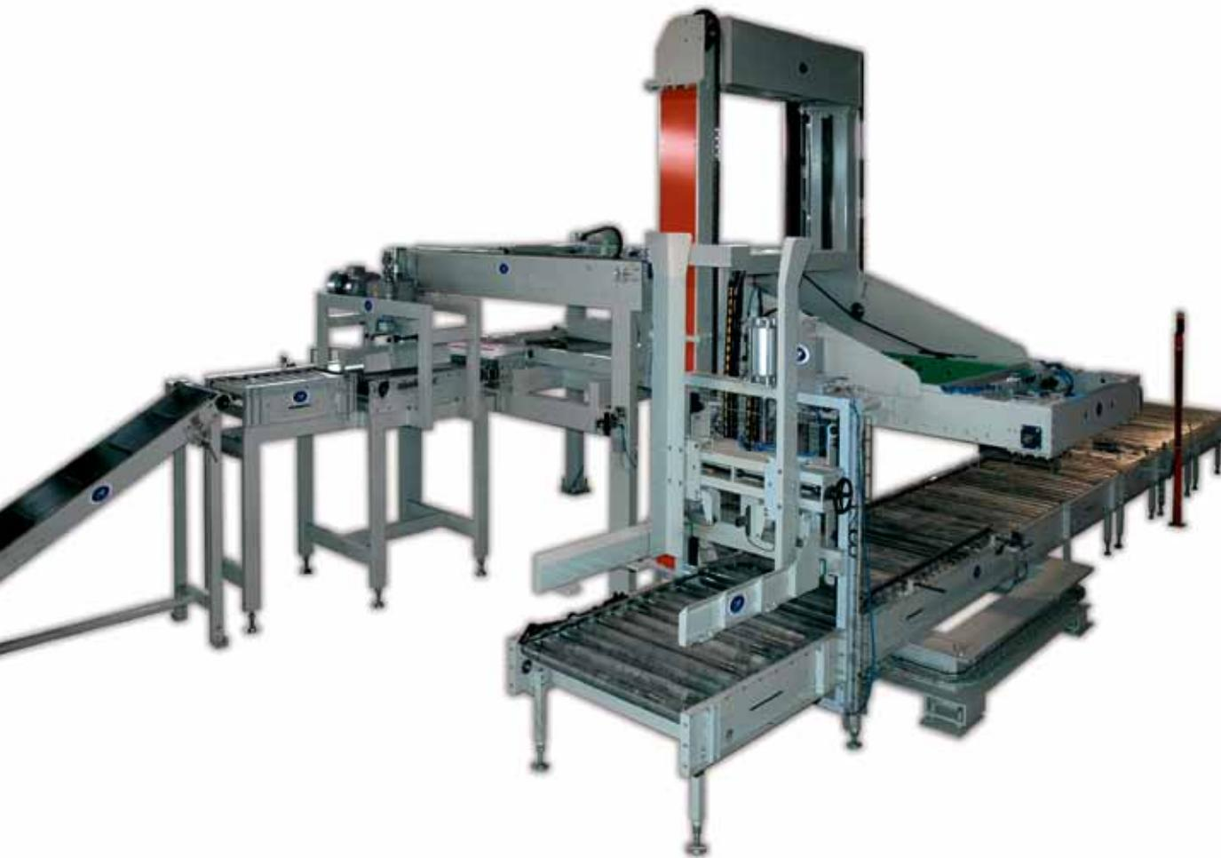
Mit dem Palettierer PSM 1500/S wird das durchshnittliche Ladesystem genutzt, wodurch die herkömmlichen Ladesysteme von unten oder von oben optimiert werden und eine Arbeitsgeschwindigkeit bis zu 1500 Säcke/Stunde erzielt werden kann.
